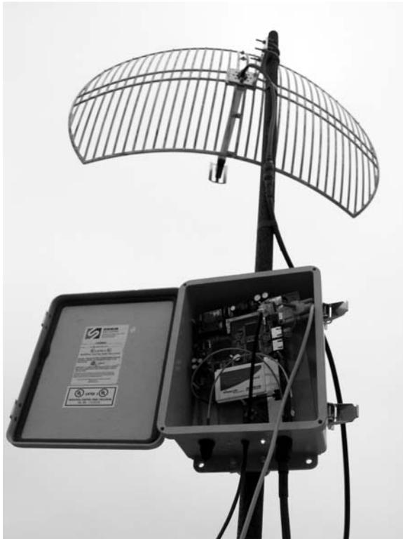
**Abb. 2-16** BARWN-Antenne mit Schaltkasten. Foto: Matt Peterson
