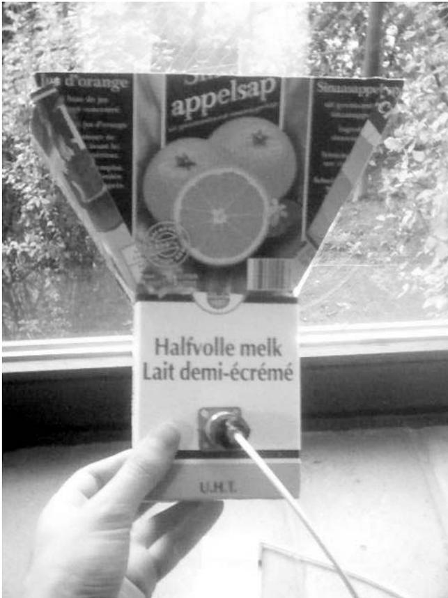
**Abb. 2-17** Tetrapak-Antenne. Foto: Réseau Citoyen
